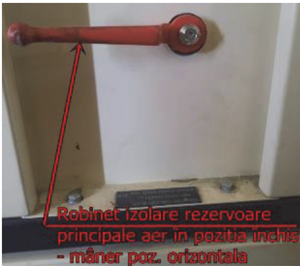
Fig. 11. Robinet izolare rezervoare principale de aer Fig. 12. Robinet izolare frână de parcare
