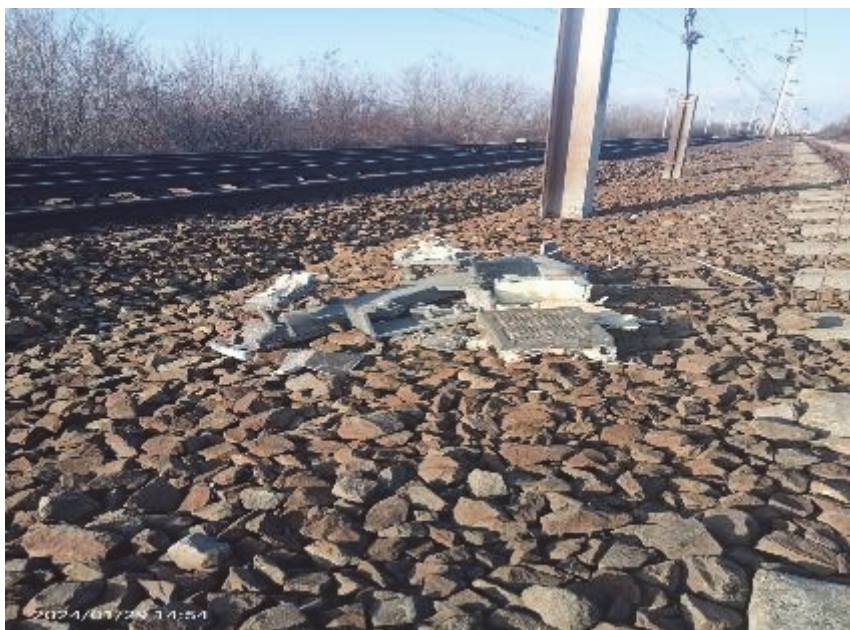
Fig. 15. Legătura de gardă și parte din inductorul aferent de pe locomotiva EA 773
