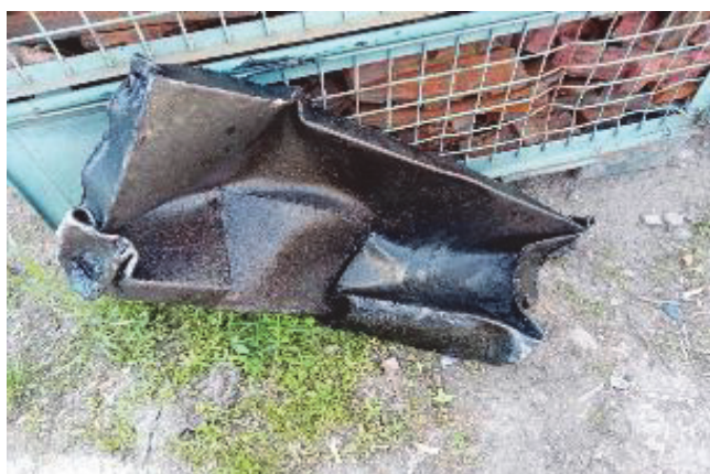
Fig. 6. Rezervor reziduuri deformat
